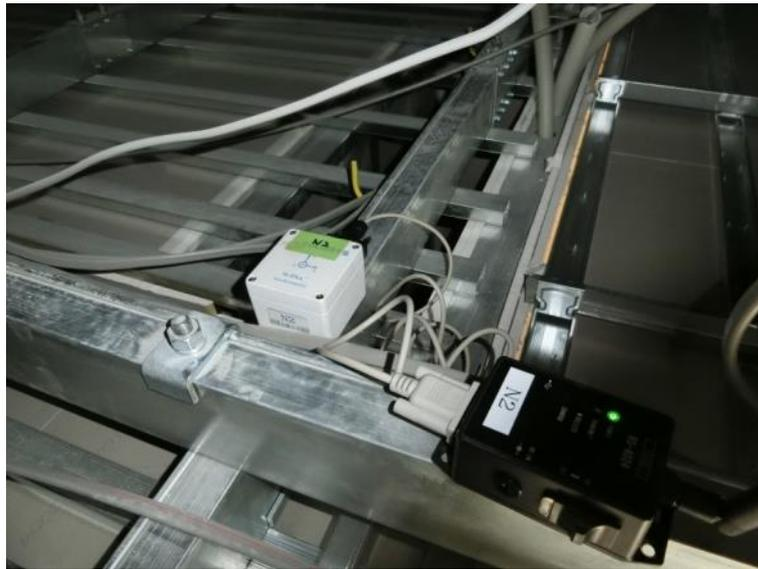
写真 19 計測点 2 センサ N2 設置状況
