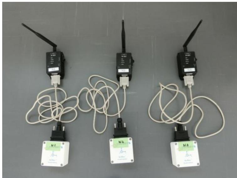
写真 1 使用機材・MEMS無線加速度計 (3台)
