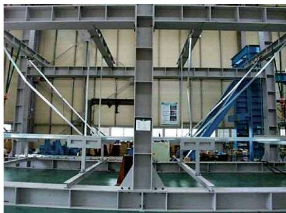
写真3 モデル1の終局状況(部材の座屈)
