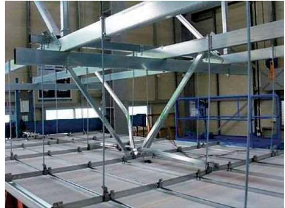
写真5 モデル5の終局状況 (斜め材の座屈)
