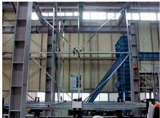
写真6 モデル7の終局状況 (部材の座屈)
