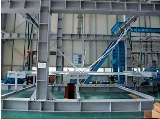
写真4 モデル4の終局状況 (部材の座屈)
