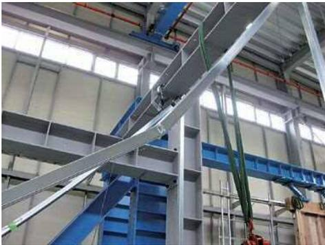
写真5 破壊状況
