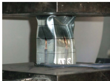
圧縮試験終局状況 (かしめ部は座屈時の大変形でもはずれない。)
