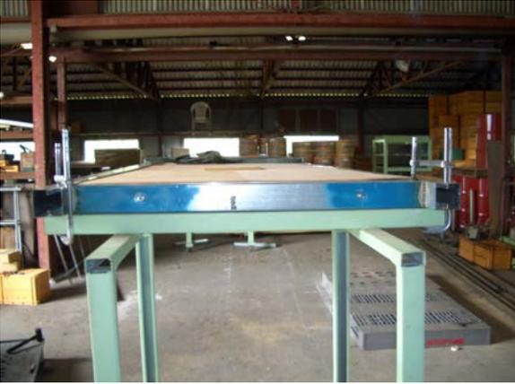
4、載荷強さ試験 測定機器取付けセット (床面より 1500 位置にて計測器セット)
