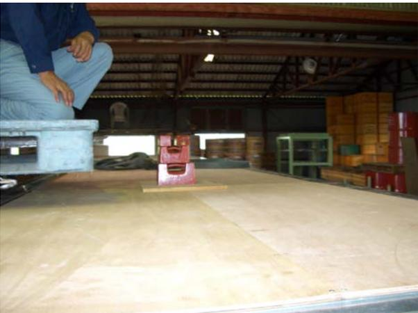
6、衝撃試験実施状況1（砂袋質量30kgを合板から高さ300mmにセットする。）
