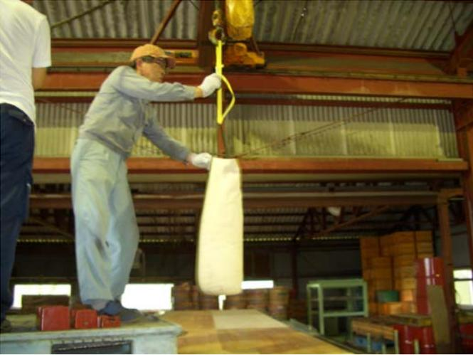
7、衝撃試験実施状況2（砂袋を落下させ、取り除いた直後に、石膏ボード面の最大残留たわみ量測定する。）
