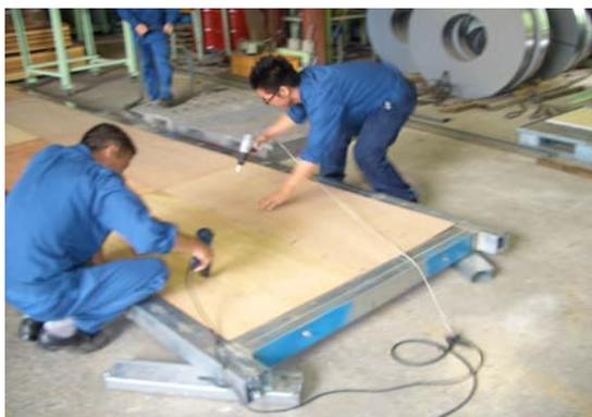
3、試験架台へ試験枠をセットする。(4か所架台固定及びレベル調整)
