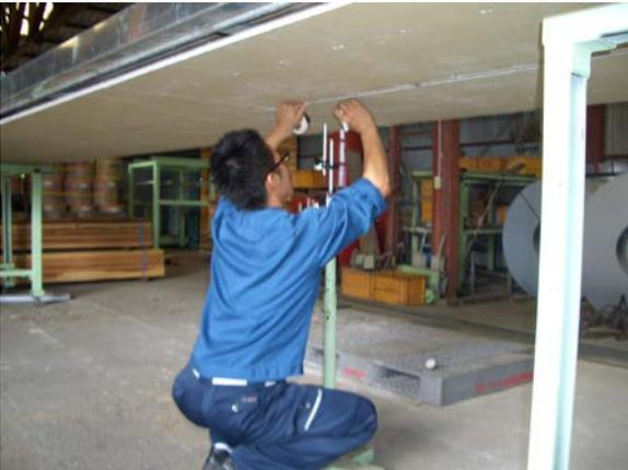
5、載荷強さ試験実施状況 (床面より上面に 1500 の位置に当て板を置き、160N の荷重を掛ける。
