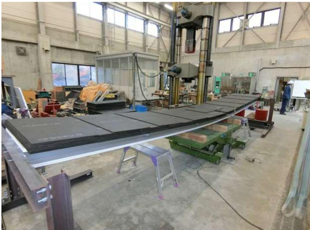
写真 2 実験風景・2500N/m<sup>2</sup>最終載荷状況（耐力保持）
