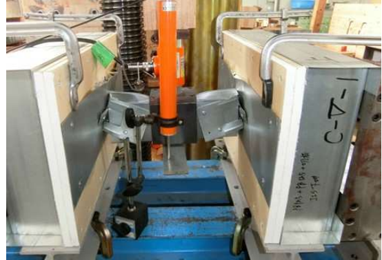
野縁受けSKH-100(□100×45×0.8)変形 端部固定金具変形
