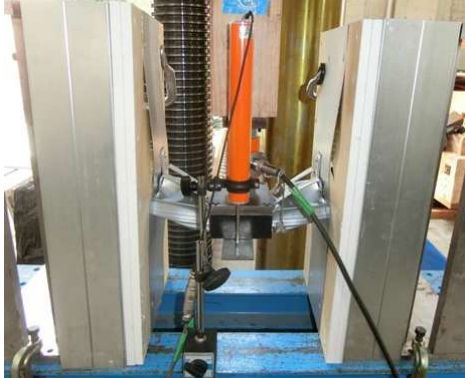
野縁受けSKH-100(□100×45×0.8)変形 端部固定金具変形
