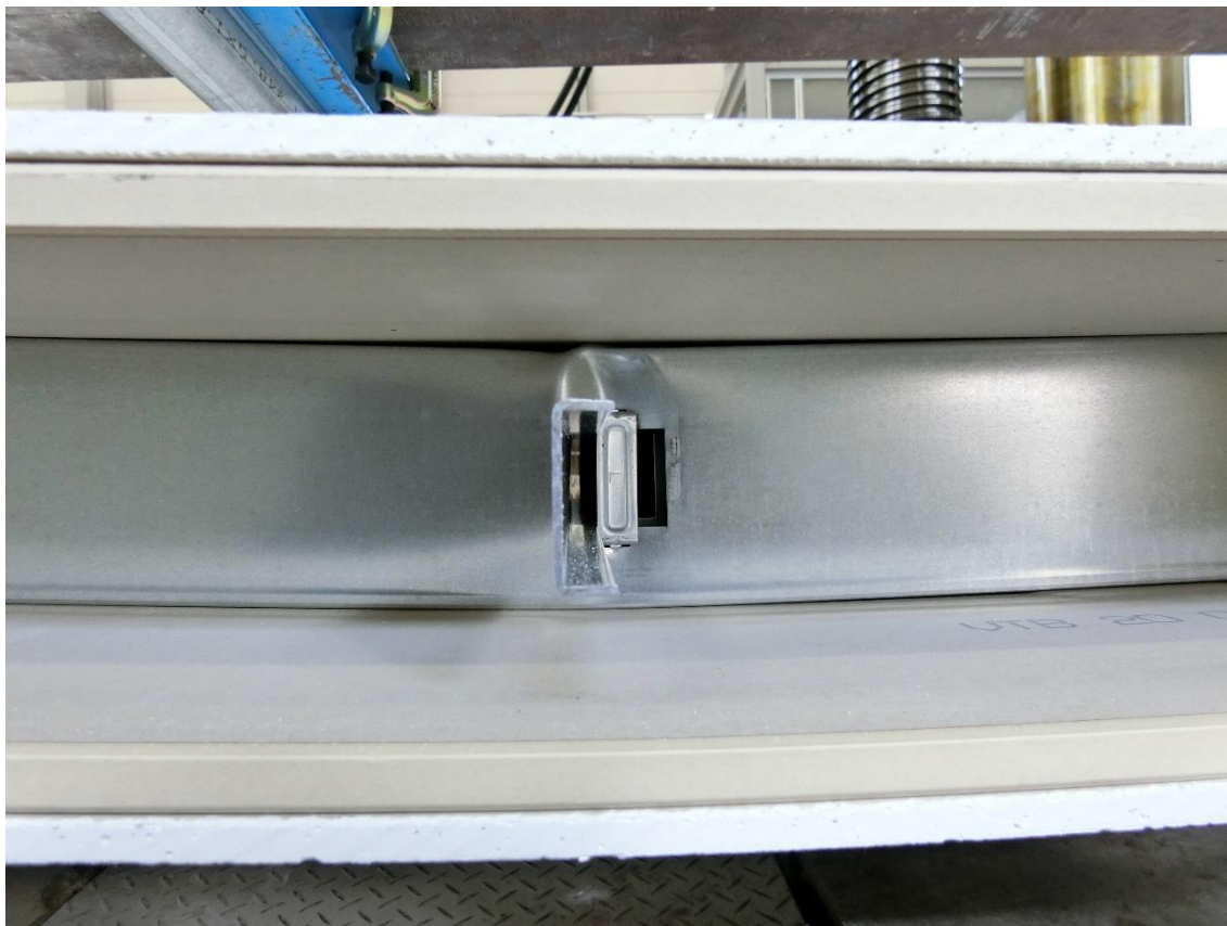
写真 2 試験体シリーズ No.6 (#01) 終局状況
