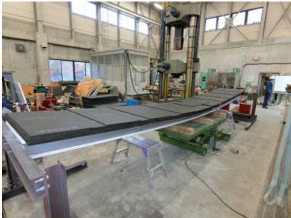
写真 2 実験風景・2500N/m 2 最終載荷状況（耐力保持）
