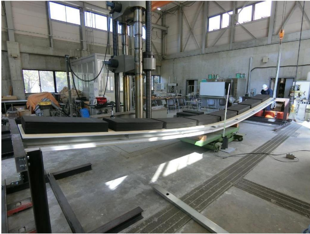
写真2 試験体No.1・最終載荷状況（耐力保持）
