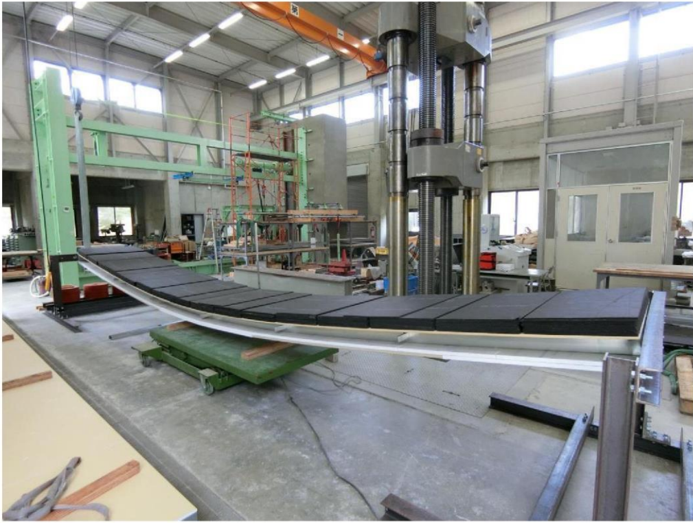
写真3 試験体No.2・最終載荷状況（耐力保持）
