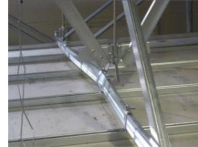
写真1 試験体1の損傷状況
