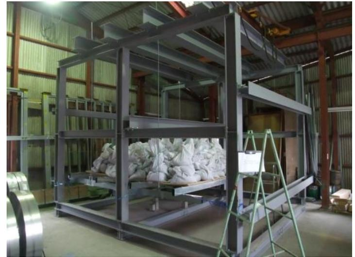
総積載荷重3トン載荷時(3260N/m<sup>2</sup>)
