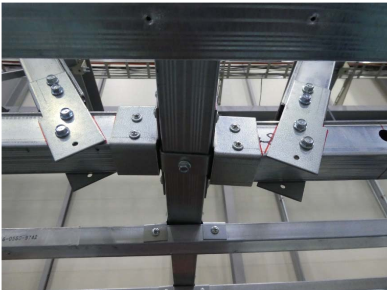
写真－5 試験体の状況（最大荷重時）
