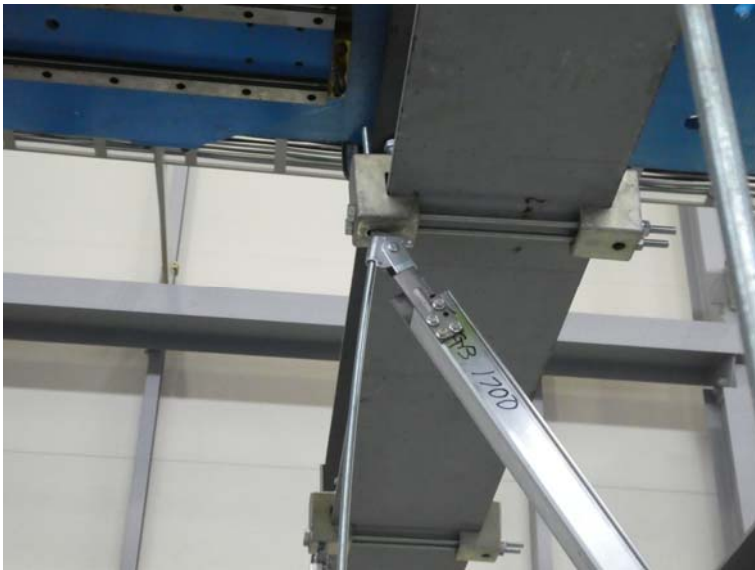
写真－10 試験体の状況（最大荷重時）
