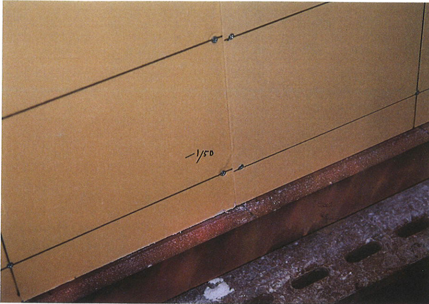
写真-4 試験状況 試験体：WS-65 \gamma = -1/50 rad時 ボードのずれ くぎのめり込み ボードの割れ
