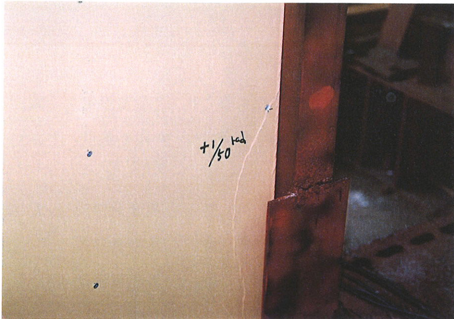
写真-7 試験状況 試験体：H-40 \gamma = 1/50 rad時 せっこうボードのずれ くぎのめり込み せっこうボードの割れ
