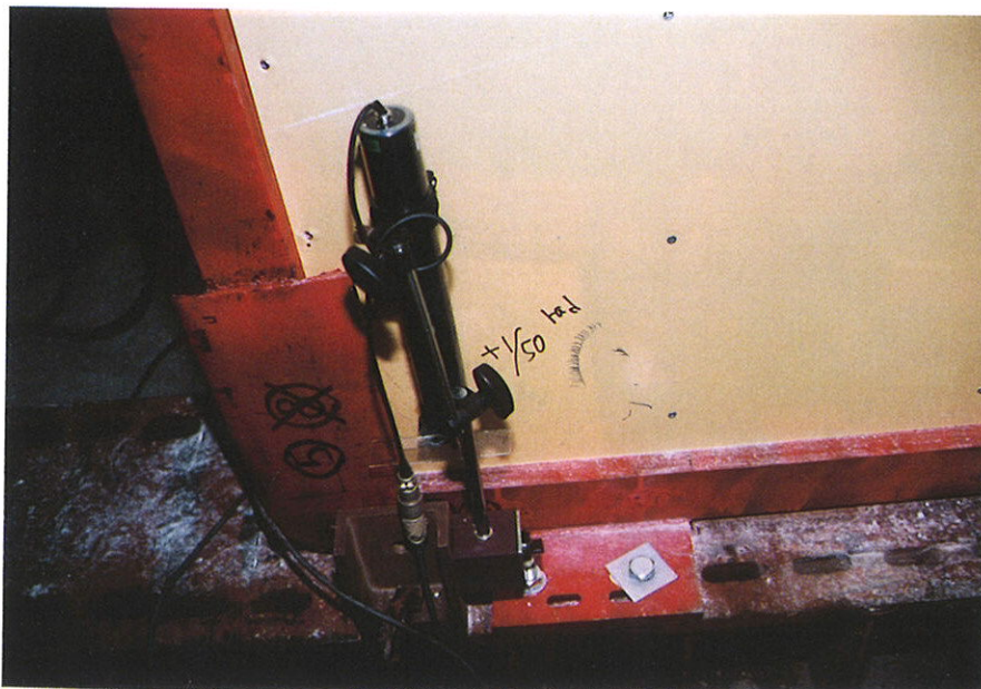
写真-3 試験状況 試験体：H-65NF \gamma = 1/50 \text{ rad} 時 せっこう ボードのずれ くぎのめり込み せっこうボードの割れ
