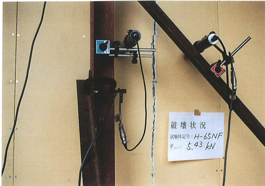
写真-2 破壊状況 (試験体記号: H65-27NF)
