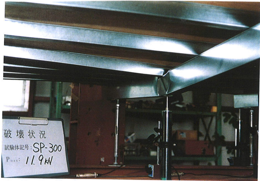
写真-2 破壊状況 (試験体記号: SP-300)
