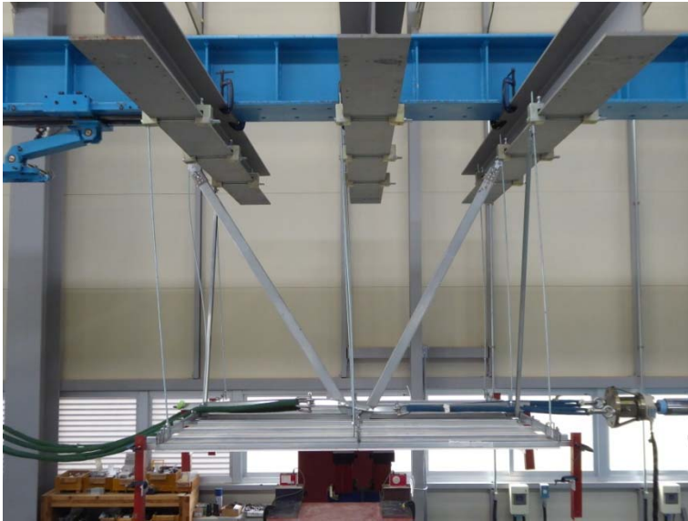
写真－9 試験体の状況（最大荷重時）
