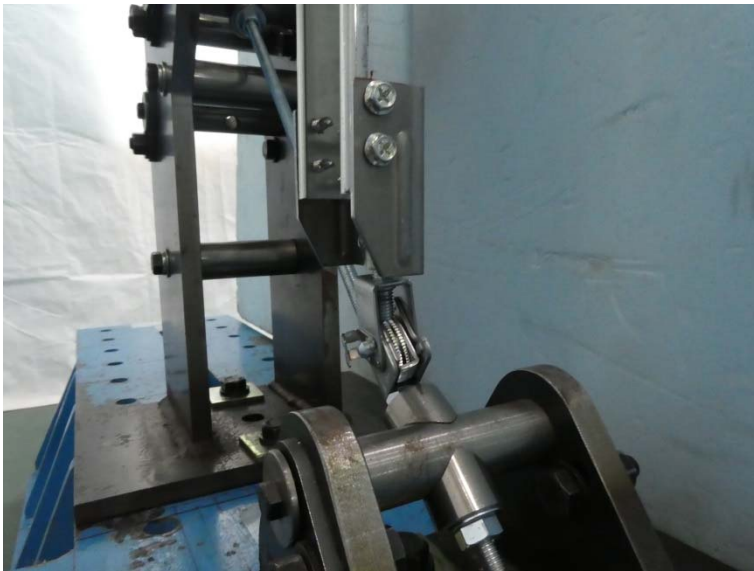
写真－6 試験体の状況（最大荷重時）
