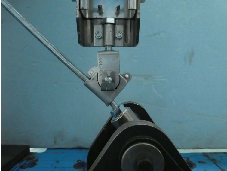
写真-3 試験体の状況（最大荷重時）
