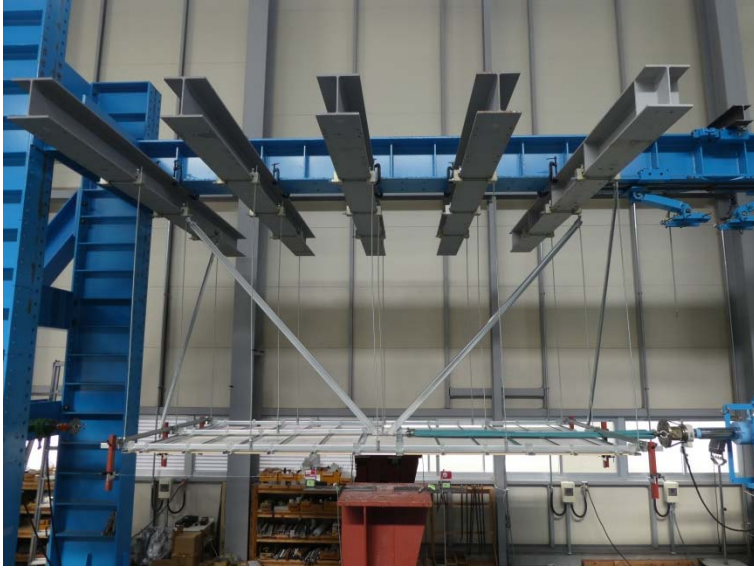
写真－6 試験体の状況（最大荷重時）
