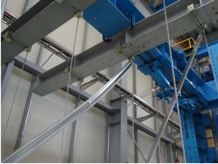
写真－9 試験体の状況（最大荷重時）
