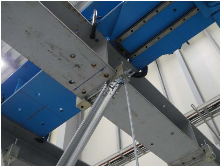
写真－10 試験体の状況（最大荷重時）
