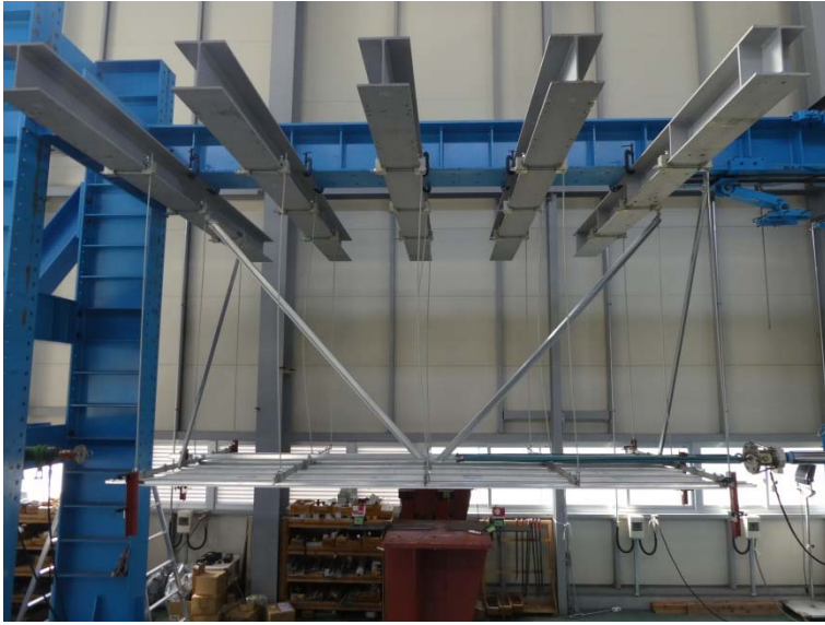
写真-3 試験体の状況 (最大荷重時)
