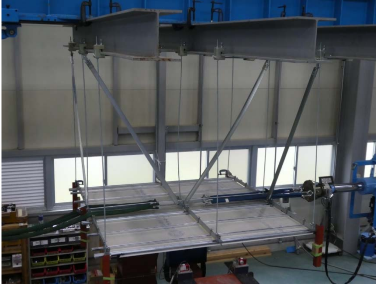
写真－9 試験体の状況（最大荷重時）
