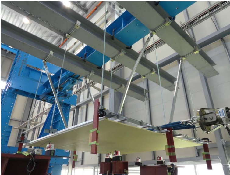
写真－7 試験体の状況（最大荷重時）
