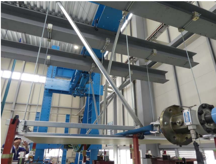
写真－10 試験体の状況（最大荷重時）
