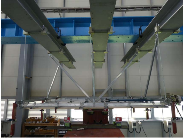
写真－6 試験体の状況（最大荷重時）
