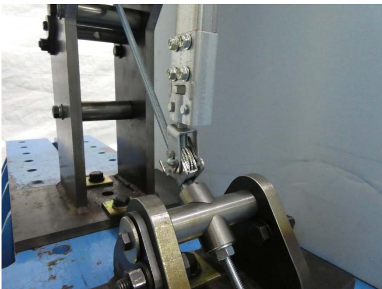
写真－7 試験体の状況（最大荷重時）
