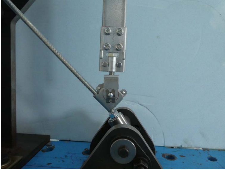
写真－8 試験体の状況（最大荷重時）
