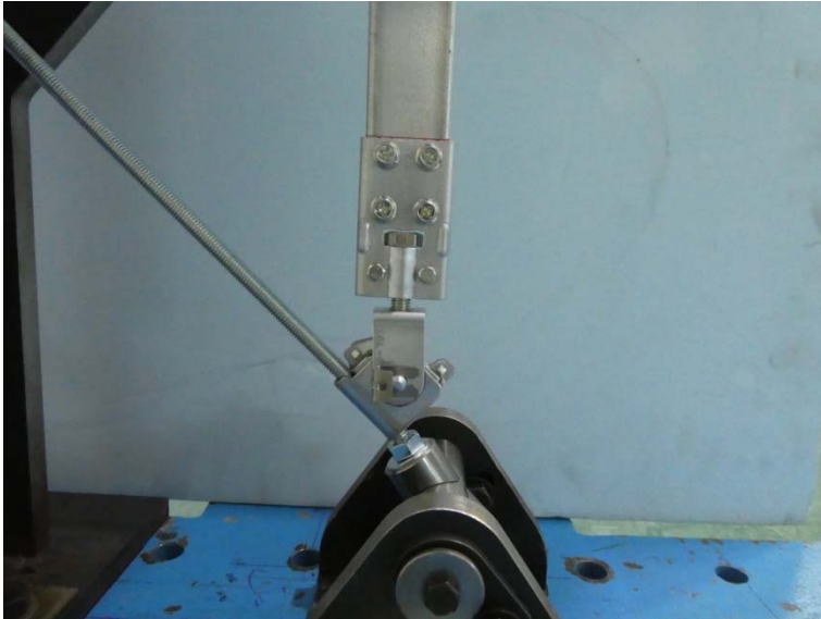
写真-3 試験体の状況（最大荷重時）
