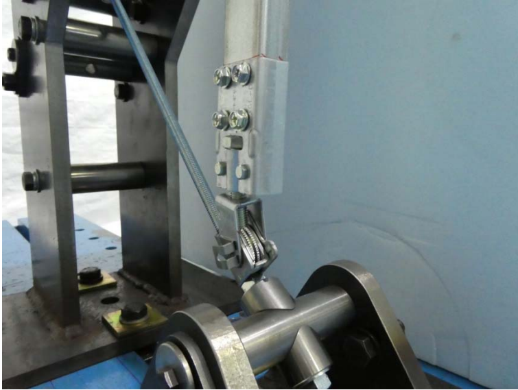
写真－5 試験体の状況（最大荷重時）
