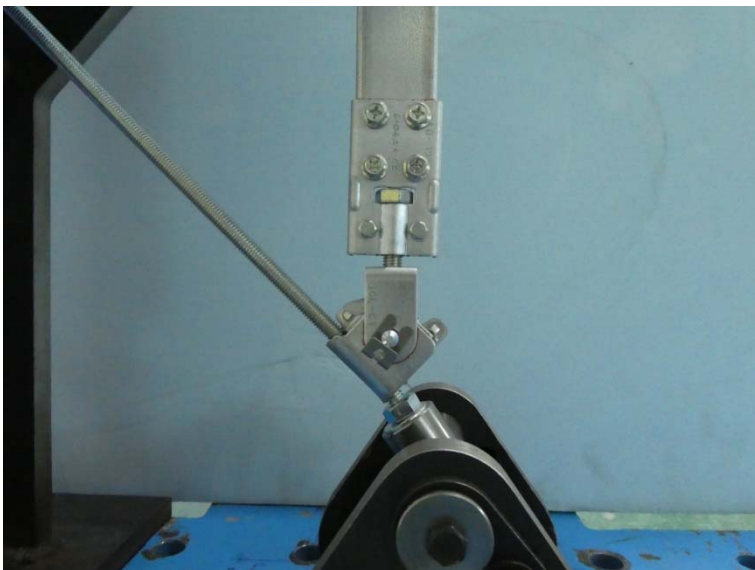
写真-4 試験体の状況（最大荷重時）
