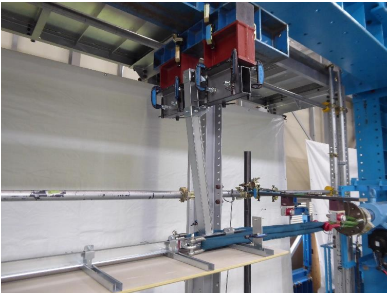
写真10 試験体の状況 試験体名：H600-NU 方向：正 最大荷重：7020N
