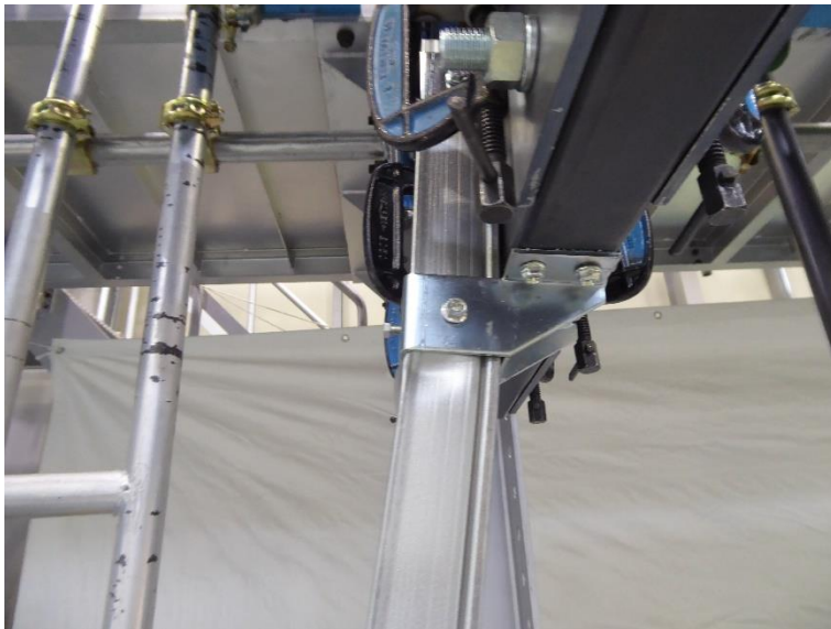
写真13 試験体の状況 試験体名：H600-NU 方向：負 最大荷重：6120N
