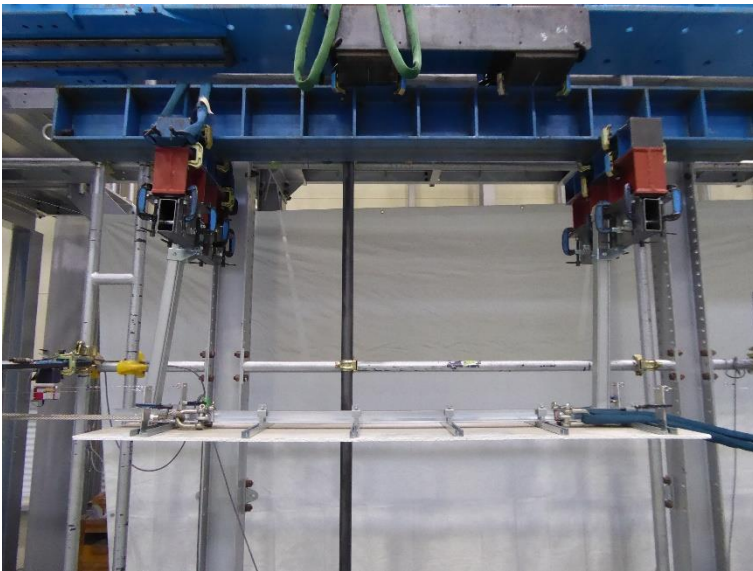
写真16 試験体の状況 (1.5Da時) 試験体名：H600-NU-K 加力方法：正負繰返し
