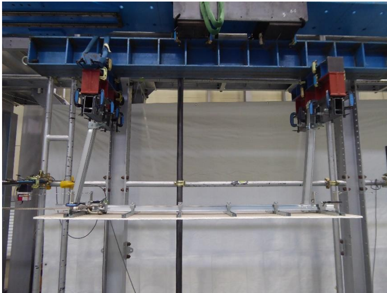
写真12 試験体の状況 試験体名：H600-NU 方向：負 最大荷重：6120N
