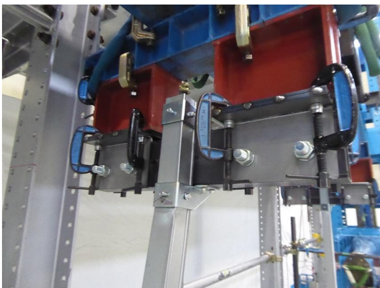
写真14 試験体の状況 試験体名：H600-NU 方向：負 最大荷重：6120N
