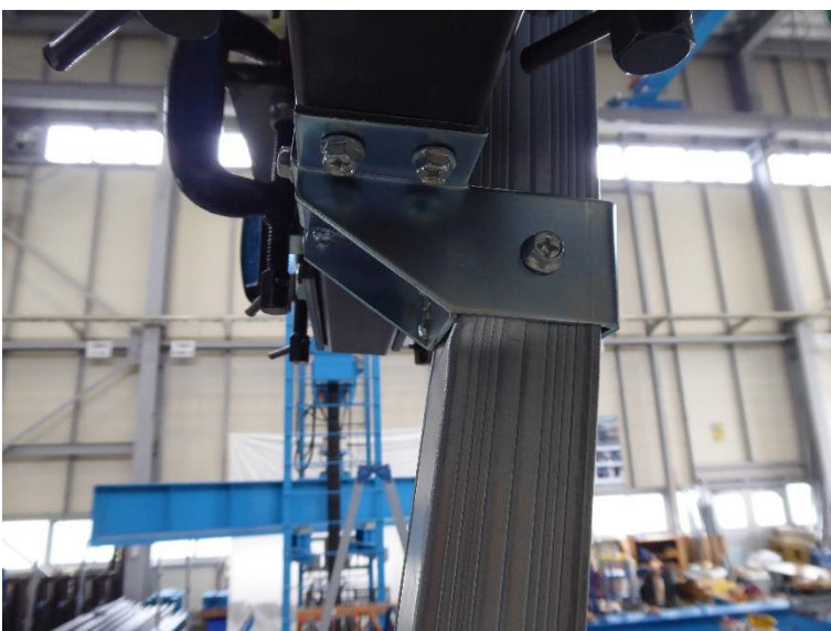
写真11 試験体の状況 試験体名：H600-NU 方向：正 最大荷重：7020N
