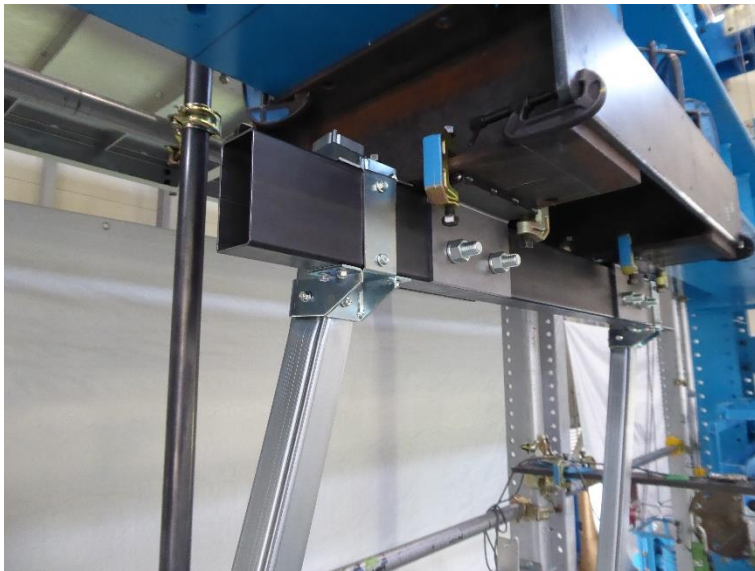
写真7 試験体の状況 試験体名：H600-N 方向：負 最大荷重：5290N
