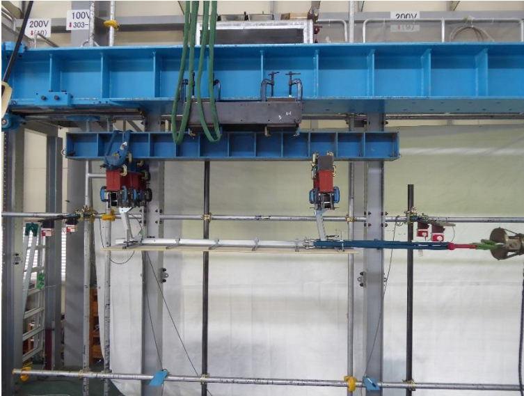
写真9 試験体の状況 試験体名：H300-NU 方向：正 最大荷重：15890N
