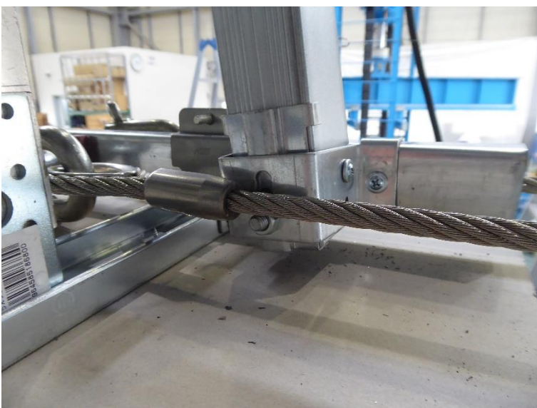
写真14 試験体の状況 試験体名：H300-NU 方向：負 最大荷重：12760N
