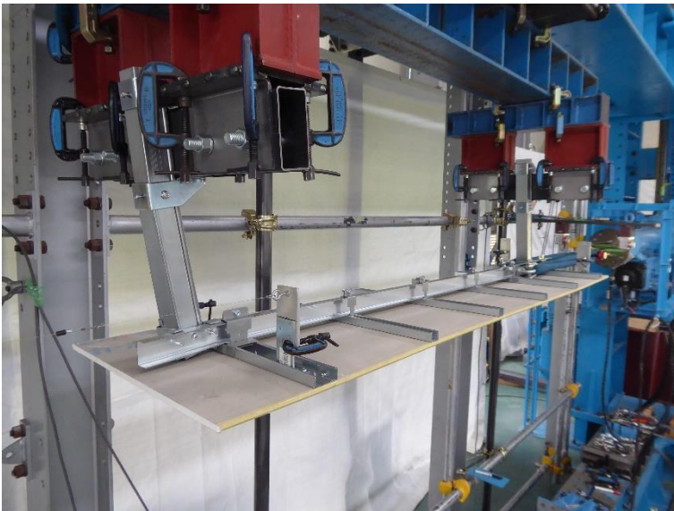
写真10 試験体の状況 試験体名：H300-NU 方向：正 最大荷重：15890N
