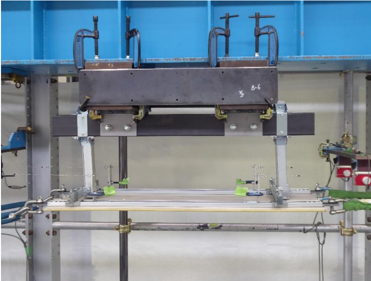
写真15 試験体の状況 (1.5Da時) 試験体名：H300-N-K 加力方法：正負繰返し
