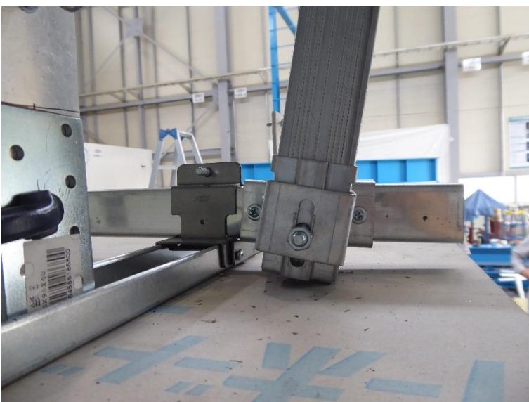
写真11 試験体の状況 試験体名：H300-NU 方向：正 最大荷重：15890N
