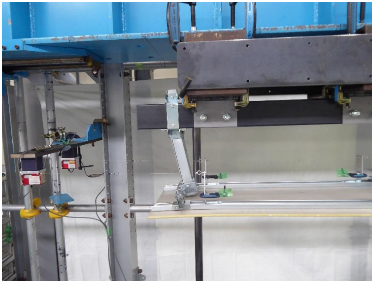
写真4 試験体の状況 試験体名：H300-N 方向：正 最大荷重：9910N
