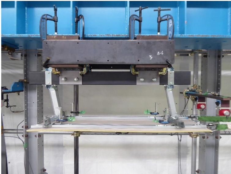
写真3 試験体の状況 試験体名：H300-N 方向：正 最大荷重：9910N
