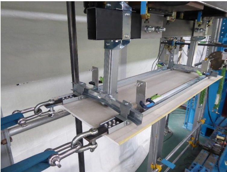
写真7 試験体の状況 試験体名：H300-N 方向：負 最大荷重：7910N
