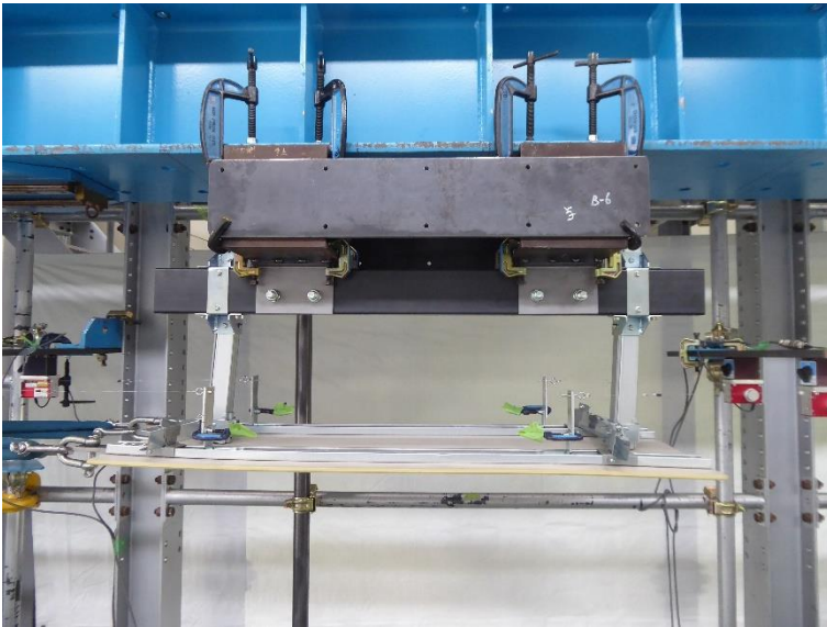
写真6 試験体の状況 試験体名：H300-N 方向：負 最大荷重：7910N
