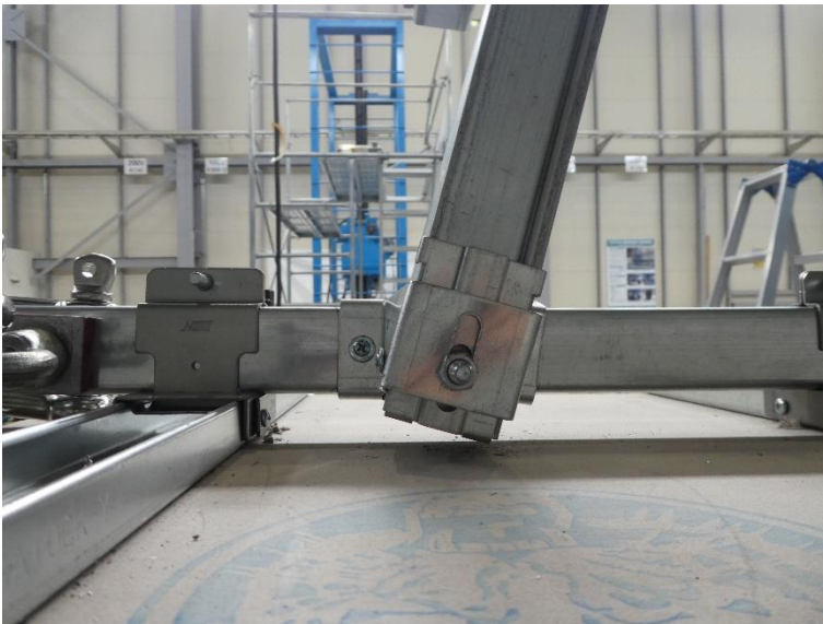
写真10 試験体の状況（最大荷重時） 試験体名：H300-NU 方向：正
