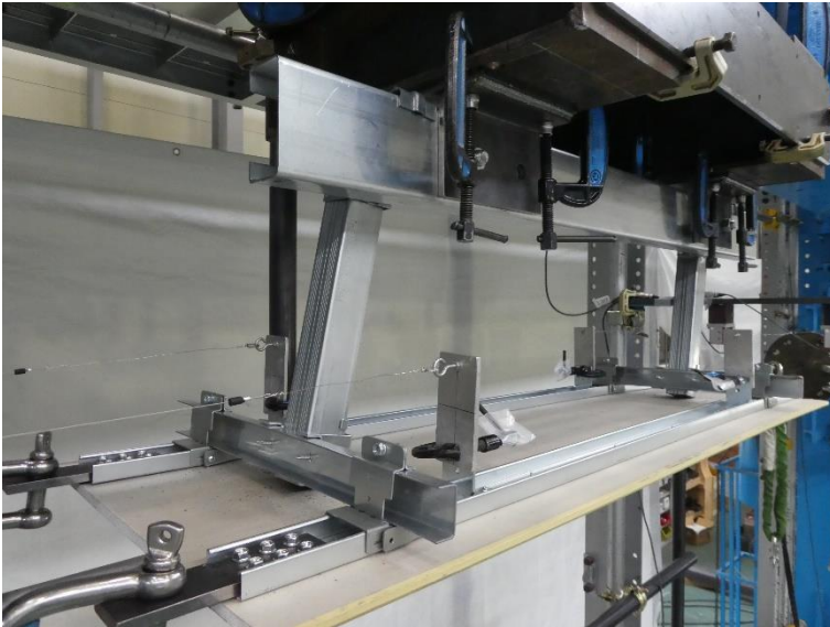
写真7 試験体の状況（最大荷重時） 試験体名：H300-N 方向：負
