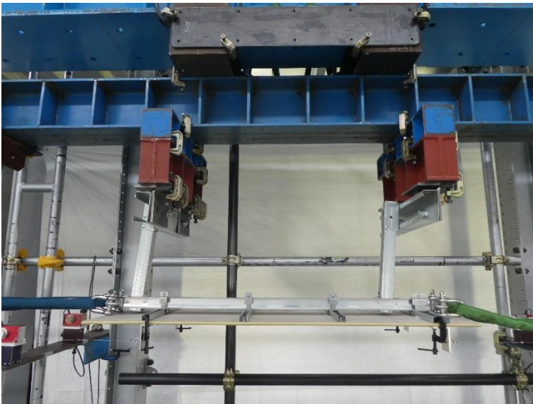
写真16 試験体の状況 (1.5Da時) 試験体名：H300-NU-K 加力方法：正負繰返し
