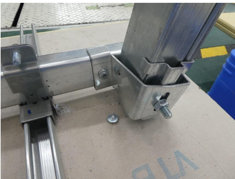
写真11 試験体の状況（最大荷重時） 試験体名：H300-NU 方向：正
