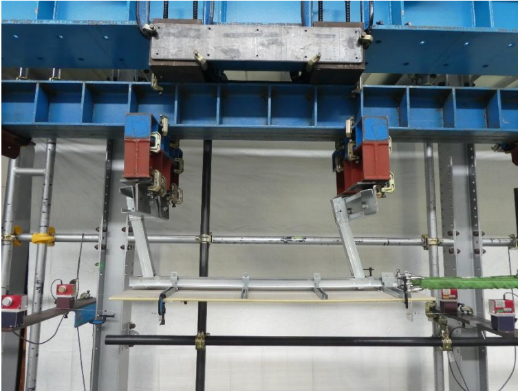
写真9 試験体の状況（最大荷重時） 試験体名：H300-NU 方向：正
