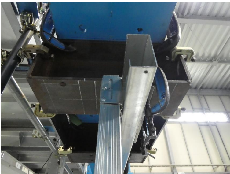
写真8 試験体の状況（最大荷重時） 試験体名：H300-N 方向：負
