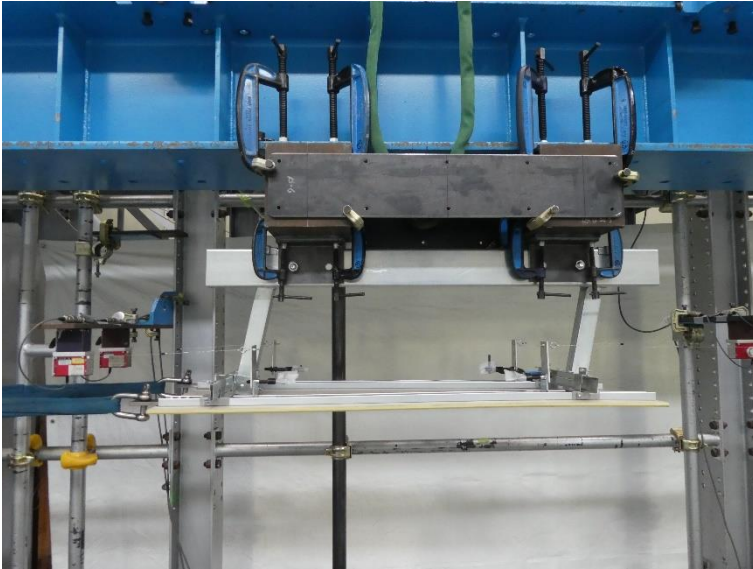
写真6 試験体の状況（最大荷重時） 試験体名：H300-N 方向：負
