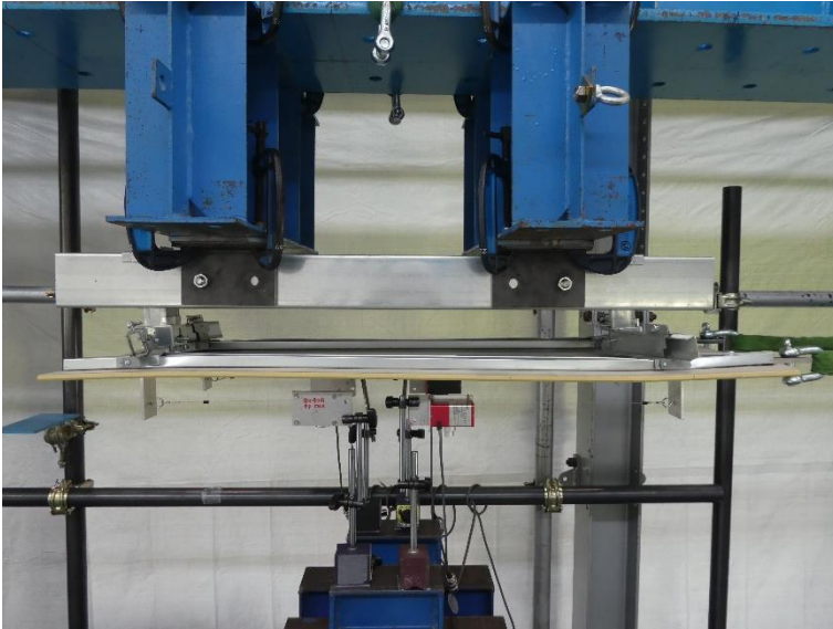
写真3 試験体の状況（最大荷重時） 試験体名：H100-N 方向：正
