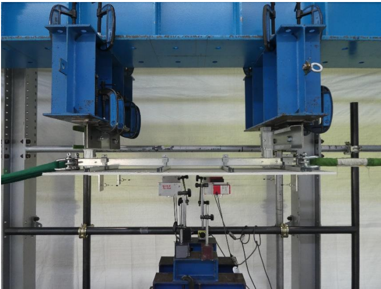
写真16 試験体の状況 (1.5Da時) 試験体名：H100-NU-K 加力方法：正負繰返し
