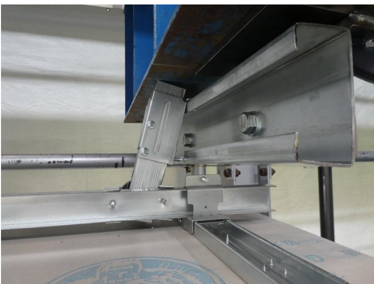
写真14 試験体の状況（最大荷重時） 試験体名：H100-NU 方向：負
