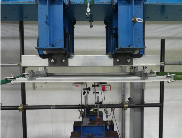
写真15 試験体の状況 (1.5Da時) 試験体名：H100-N-K 加力方法：正負繰返し
