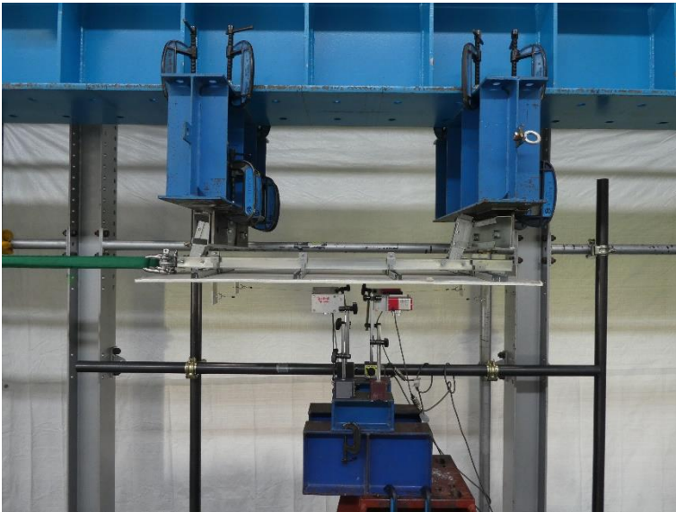
写真12 試験体の状況（最大荷重時） 試験体名：H100-NU 方向：負
