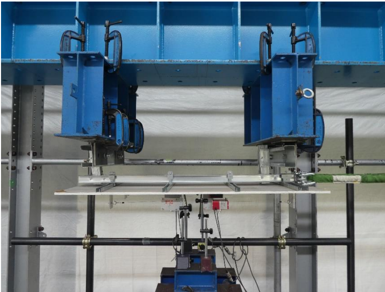
写真9 試験体の状況（最大荷重時） 試験体名：H100-NU 方向：正
