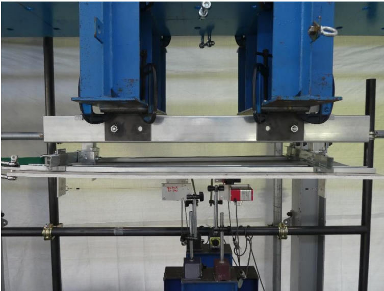
写真6 試験体の状況（最大荷重時） 試験体名：H100-N 方向：負
