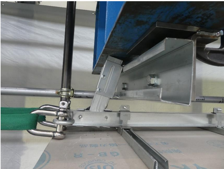
写真13 試験体の状況（最大荷重時） 試験体名：H100-NU 方向：負
