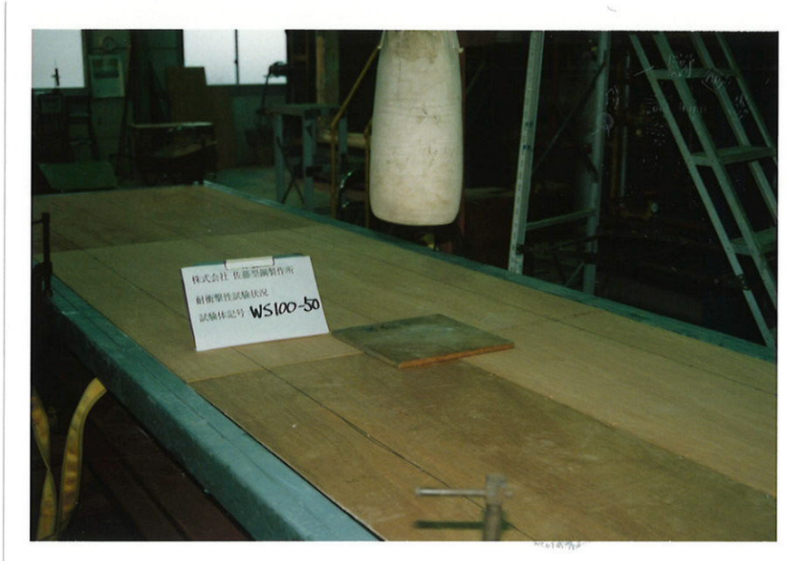
写真-2 耐衝撃性試験状況
