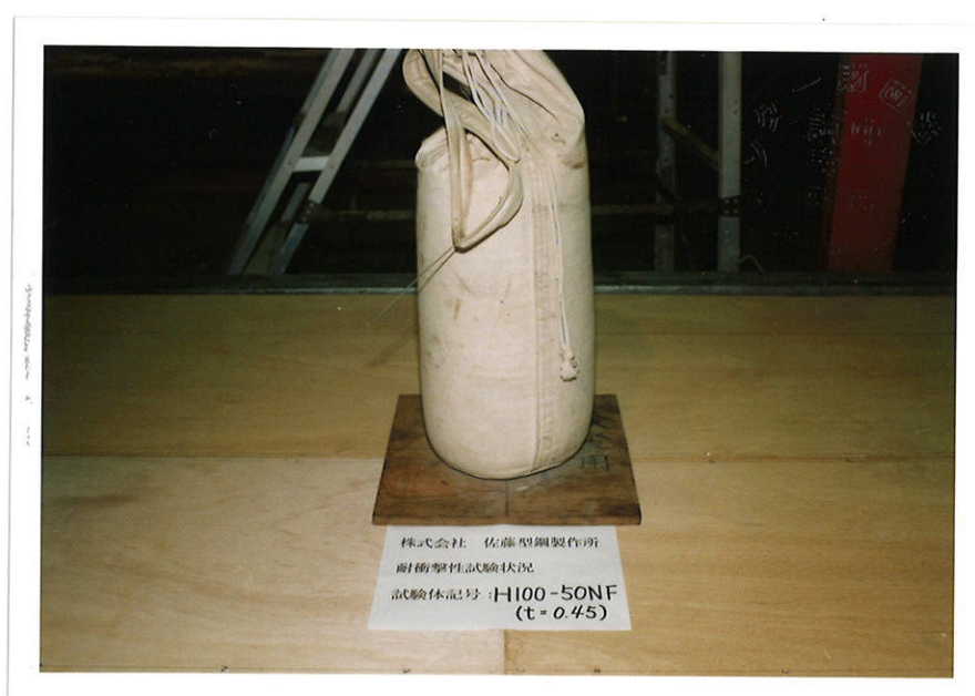
写真-2 耐衝撃性試験状況 (H100-50NF t=0.45mm)
