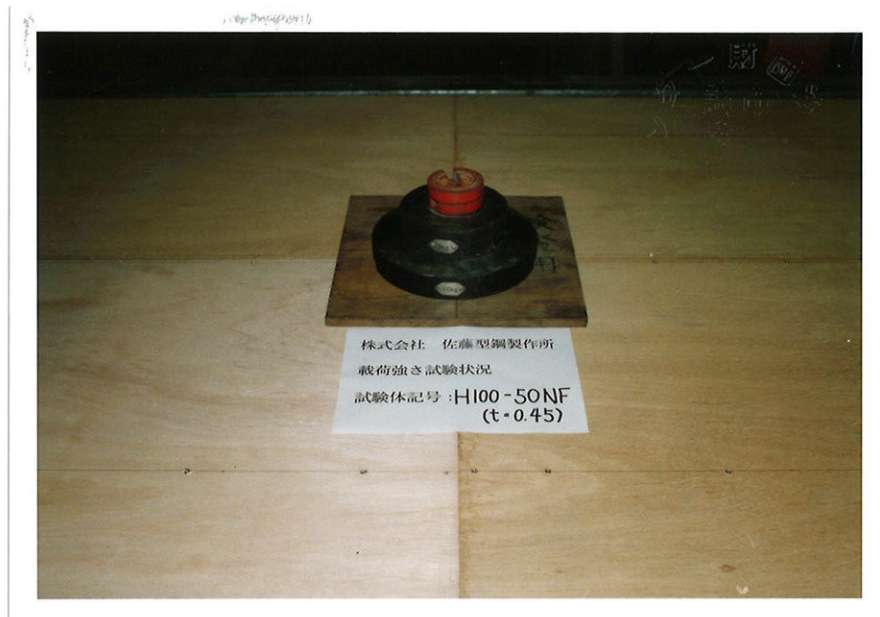
写真-1 載荷強さ試験状況 (H100-50NF t=0.45mm)
