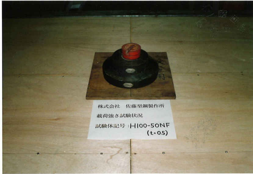
写真-3 載荷強さ試験状況 (H100-50NF t=0.5mm)
