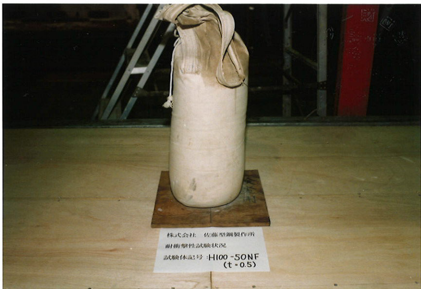
写真-4 耐衝撃性試験状況 (H100-50NF t=0.5mm)
