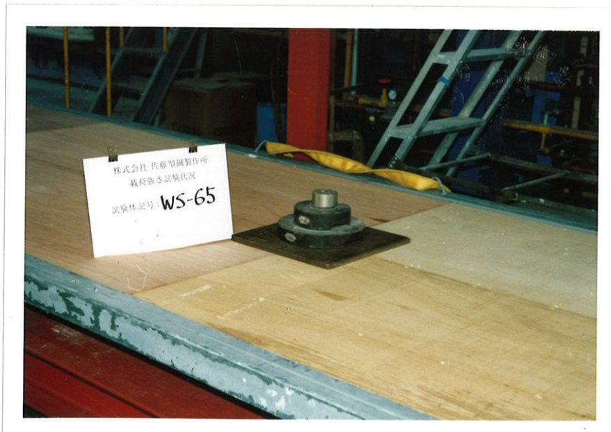
写真-1 載荷強さ試験状況
