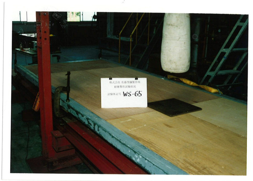
写真-2 耐衝撃性試験状況
